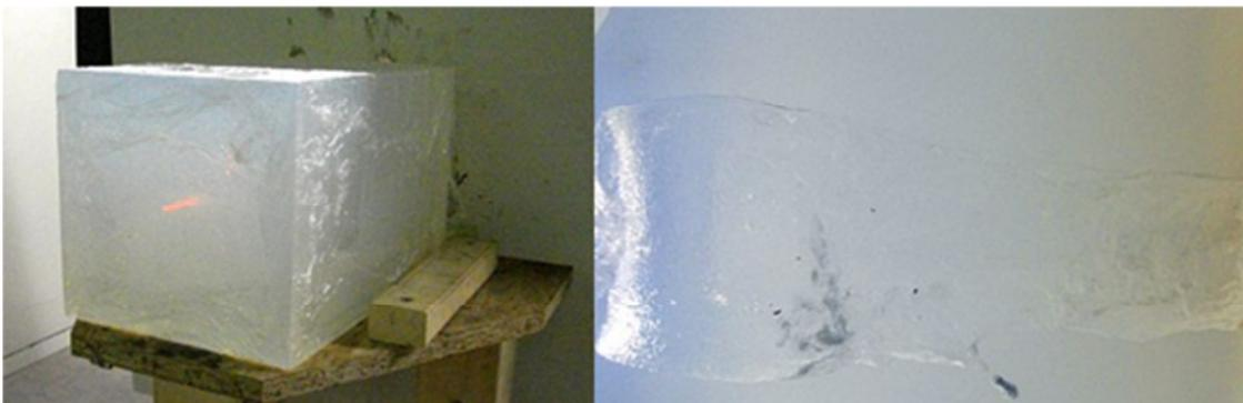
Abbildung 3: Seifenblock im Versuchsaufbau vor Beschuss und nach Beschuss im Schnittbild
