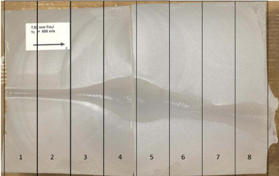
Abbildung 6: Segmenttraster zur lagespezifischen Auswertung der Geschosswirksamkeit (Schichtstärke 5 cm, Ordinalskalierung). Einschuss auf der linken Seite des Blockes.
