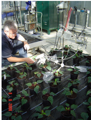
Abbildung 3: Phytomonitoringsystem mit Robosensor an Euphorbia pulcherrima Willd. ex Klotzsch und Datengewinnung.
