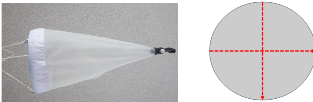
Abb. 4: Zugnetz (links) und Beprobungsschema für Zugnetzbeprobung (rechts, je 5.6 m pro Linie) für Planktonorganismen in den RPE-Versuchen.
