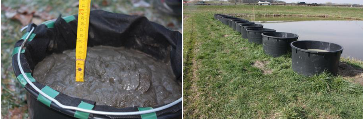
Abb. 16. Versuchseinheit I und II. Links: Kleine Behälter 12 L (KE). Rechts: Grosse Behälter mit 600 L Inhalt (GB).
