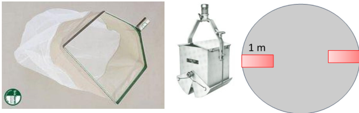
Abb. 6: Kick-Netz Sample-Kescher (links), Eckman-Sedimentgreifer (Mitte) und Beprobungsschema (rechts) für Benthosorganismen in den RPE-Versuchen.
