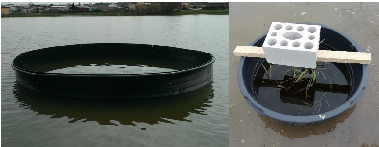
Abb. 9: Links: Runde Plastik-Versuchseinheiten (RPE) im Teich (25 m 2 Fläche). Rechts: Kleine runde Plastik-Versuchseinheiten (KRPE, angestaut auf ca. 70 L) mit Beschwerung gegen Aufschwimmen.
