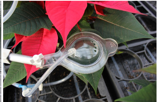
Abb. 32: Blattküvette zur Gaswechsellmessung an Euphorbia pulcherrima 'Bella Italia Red', 2013
