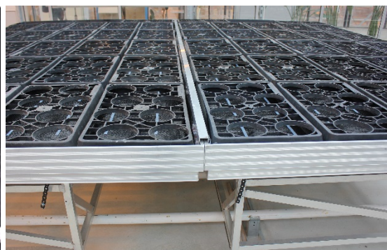
Abb. 25: gekoppelter Vibrationstisch mit Aluminium-Profilsschiene
