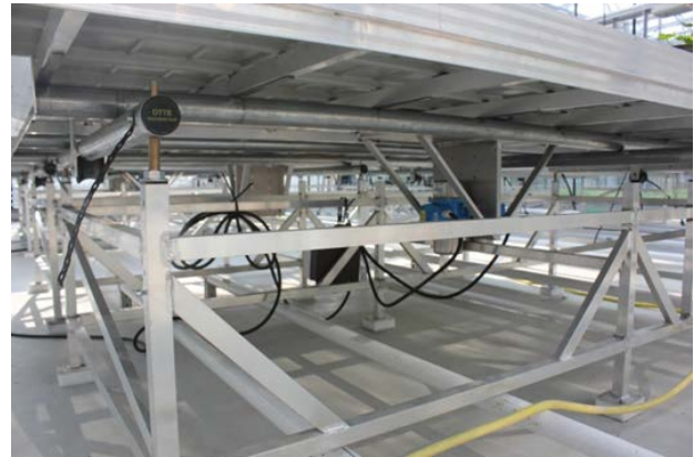
Abb. 7: Vibrations-Rolltisch mit Unwuchtmotoren (von unten)
