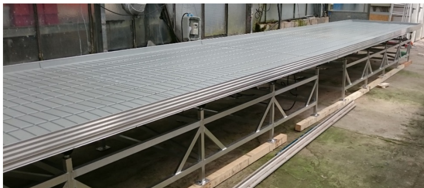
Abb. 10: Vibrations-Rolltisch (9,5 m x 1,61 m) im Praxisbetrieb Fleischle, 2016
