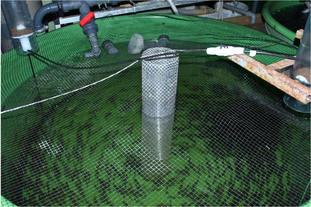
Abb. 6: Rundbecken einer Kreislaufanlage für die Intensiv-Aufzucht am Standort Institut für Binnenfischerei e.V. Potsdam-Sacrow
