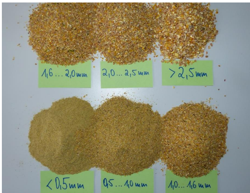
Abbildung 42: Partikelgrößen einer Siebanalyse: Im Bereich unter 0,5 mm sind Feinanteile (z.B. Mineral-Vitamin-Premix) zu finden, der gewünschte Bereich 1,0-2,0 mm beinhaltet v.a. vermahlene Getreide und Extraktionsschrote und der Bereich über 2,5mm stellt die Grobanteile mit ganzen Körnern und Bruchstücken von Getreide und vereinzelt Proteinträgern dar.
