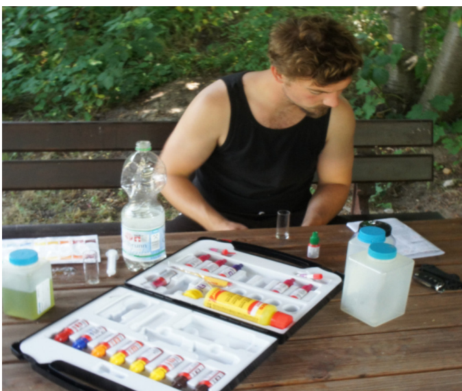
H Zur Ermittlung der wichtigsten chemischen Wasserparameter reicht ein Messkasten aus der Aquaristik.
