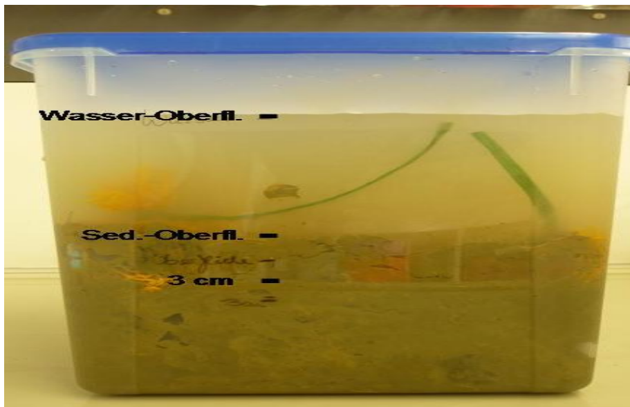
Abbildung 1: Laborteich mit eingebrachten Sandwichkeimträgern
