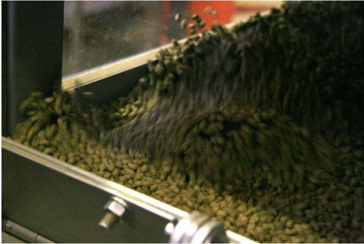
Abbildung 8: Nahaufnahme der fluidisierten Futterpellets während der Trocknung.
