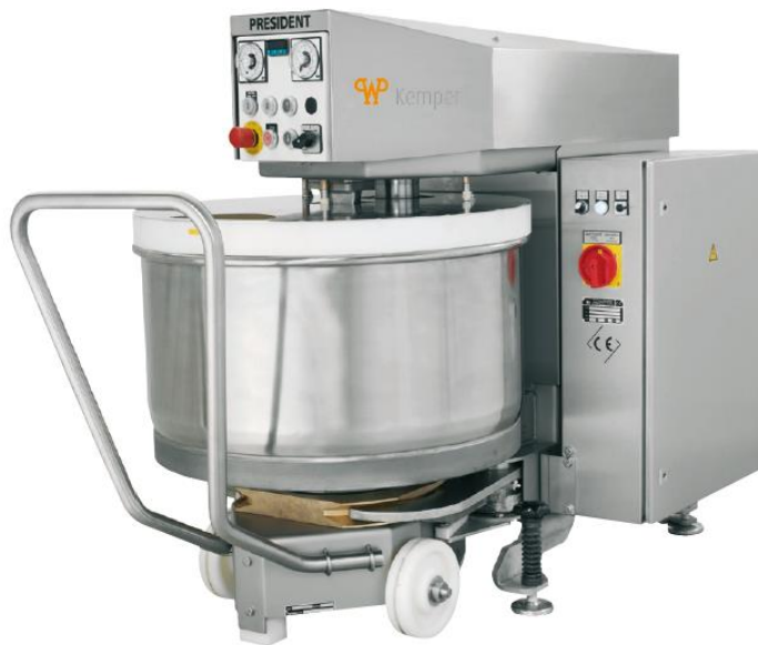
Abbildung 10: Spiralknetter „President“ der Firma „Kemper“ in dem der Coatingprozess der Futterpellets durchgeführt wurde.
