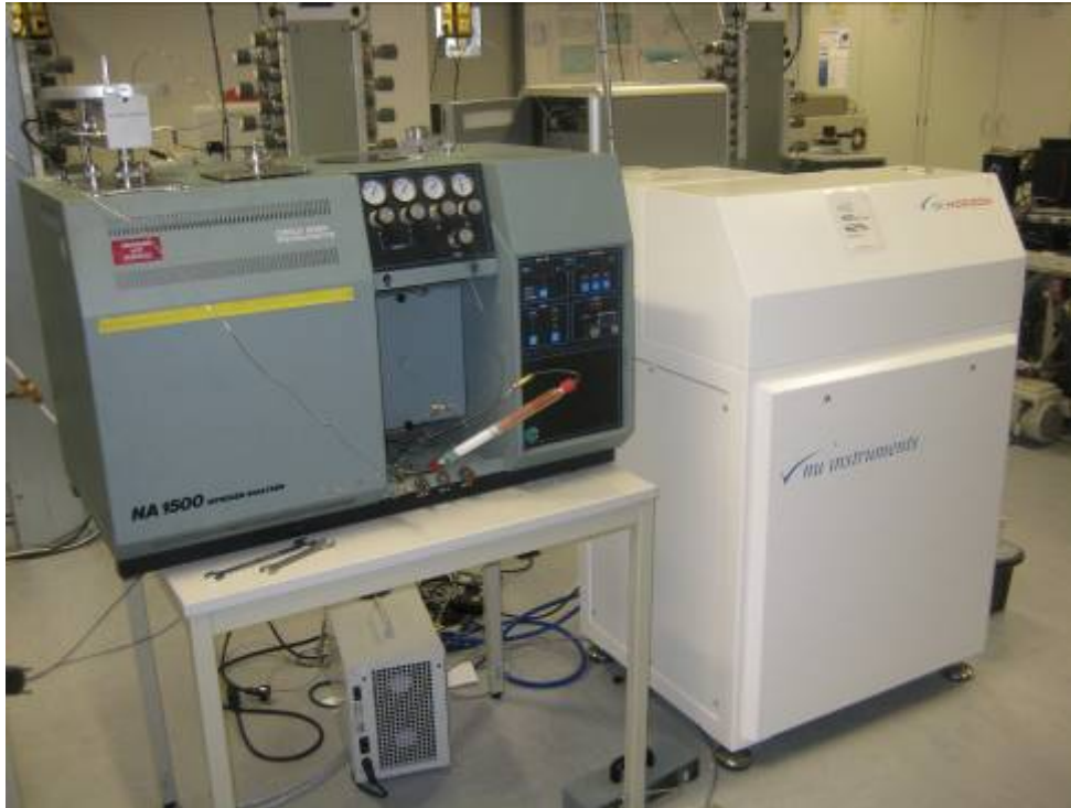
Abbildung 4: Kombination Elementanalysator mit Isotopenmassenspektrometer zur Messung der ^{13}\text{C}/^{12}\text{C} - und ^{15}\text{N}/^{14}\text{N} -Isotopenverhältnisse
