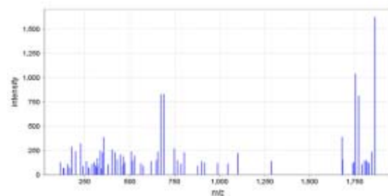
Abbildung 47: MALDI-TOF-MS/MS-Spektren des Proteins aus Spot-ID 6723. A =Peptide Mass Fingerprint (PMF). B = MS/MS Ion Search (MIS). Identifizierung via MIS: Datenbank Triticum. Precursor 1861.8402 m/z
