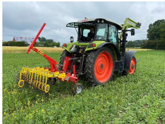
Abbildung 51: Messung mit H-Sensor in der Fronthydraulik des Schleppers (l.), Rollstriegelsegment mit automatischem, hydraulischem Aushub (r.)
