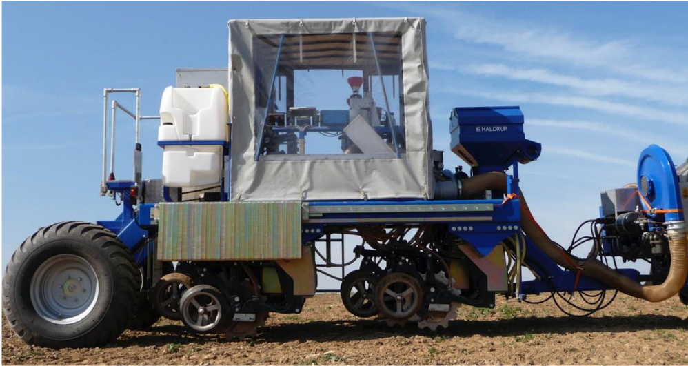
Abbildung 140: Direktsaatparzellen-Drillmaschine des ZAFT e.V. an der HTW Dresden, ausgestattet mit Cross Slot Säscharen (Foto: Schmidtke, 2015)
