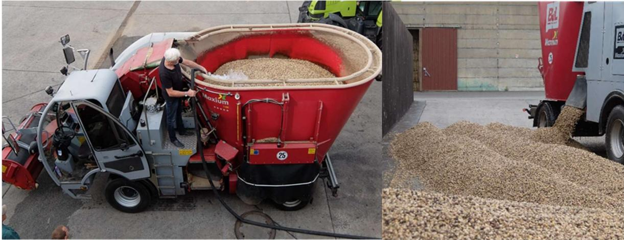
**Abbildung 4:** Großtechnische Rückbefeuchtung von trockenreifen Ackerbohnenkörnern auf 70 % TM
