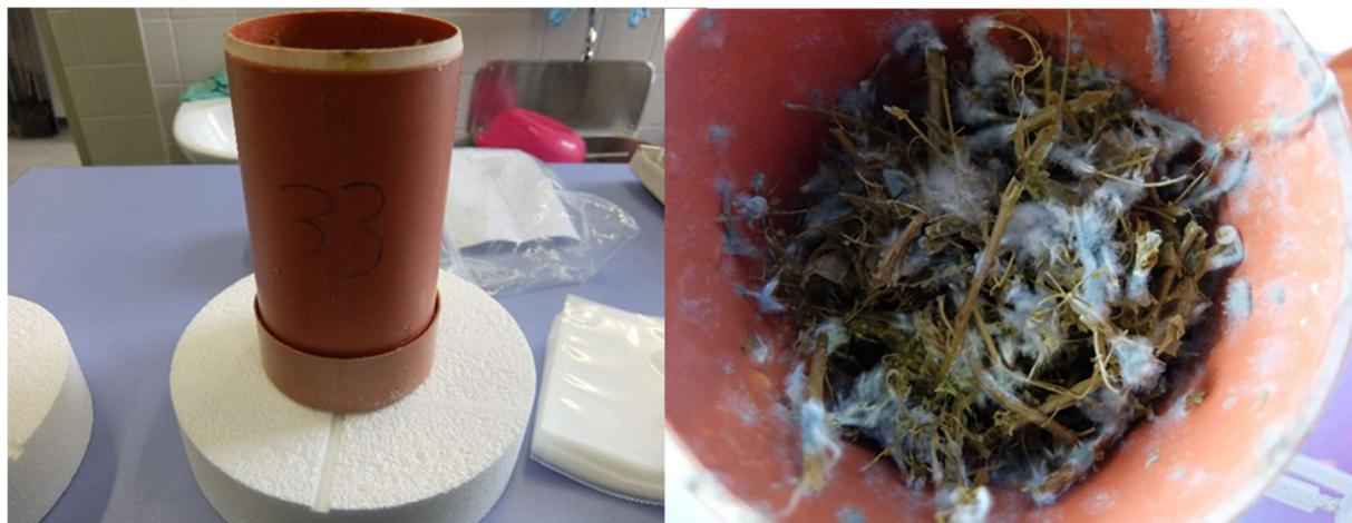
**Abbildung 9:** Aerobes Stabilitätstest (links, Behälter; rechts, Schimmelbildung bei silierten Erbsenganzpflanzen nach 7 Tagen aerober Lagerung)
