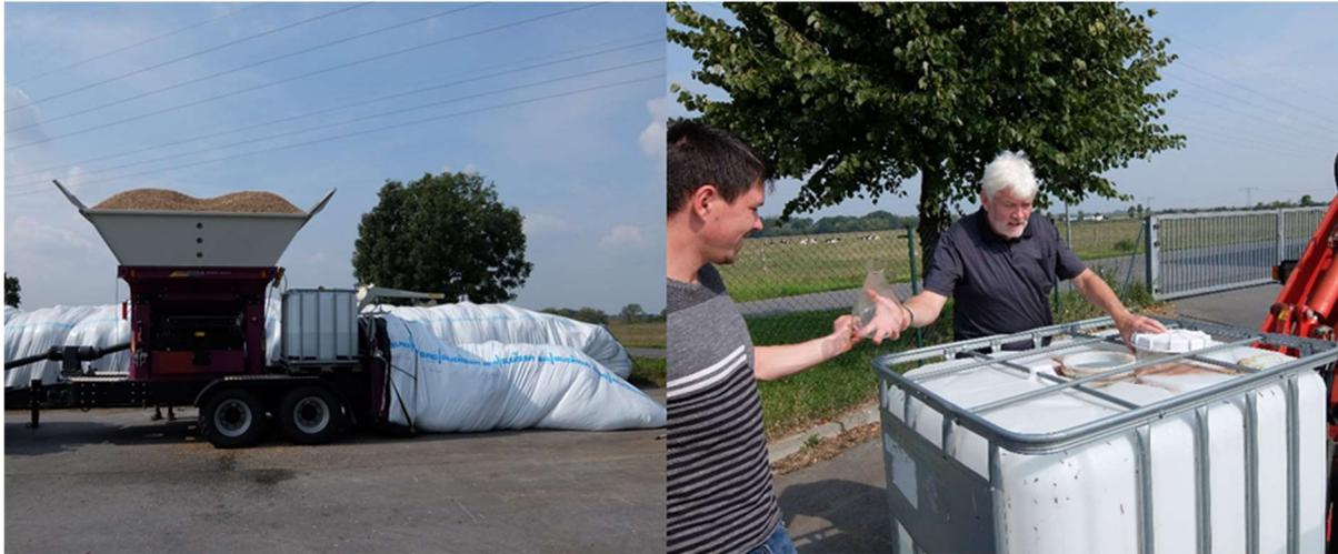
**Abbildung 6:** Großtechnische Zerkleinerung und Silierung mit Siliermittelzugabe (MSB) der Leguminosenkörner
