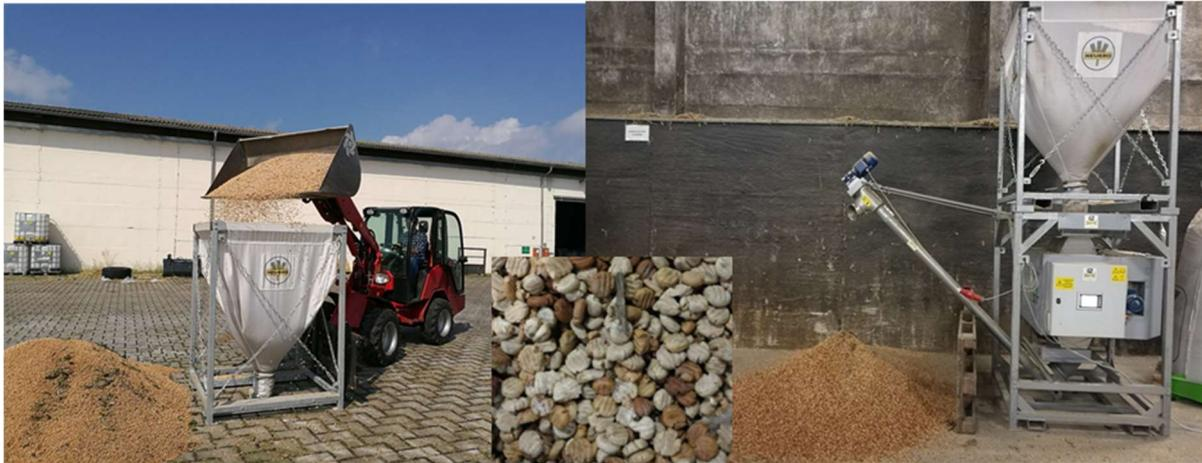
**Abbildung 8:** Thermisches Aufbereiten silierter Erbsen (links, Befüllen des Vorratsbehälters; rechts, mobile Toastanlage, ECO-Toast, Agrel)
