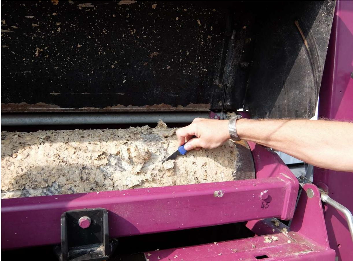
**Abbildung 32:** Verklebte Quetschwalzen der Murska 2000 beim quetschen rückbefeuchteter Ackerbohnen (70 % TM)
