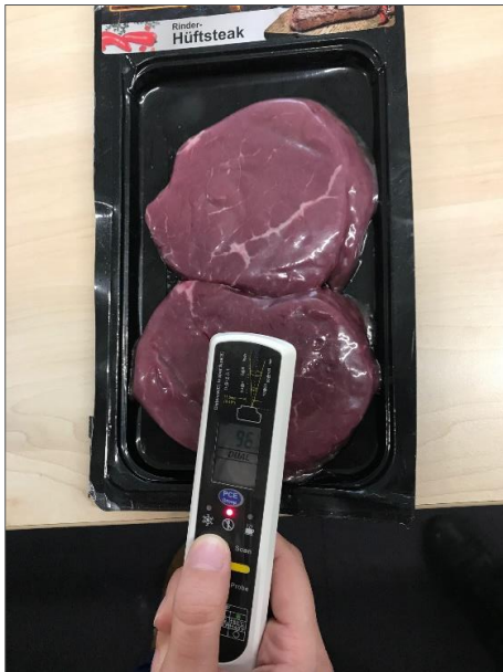
Abbildung 5: Zerstörungsfreie Messung der Oberflächentemperatur
