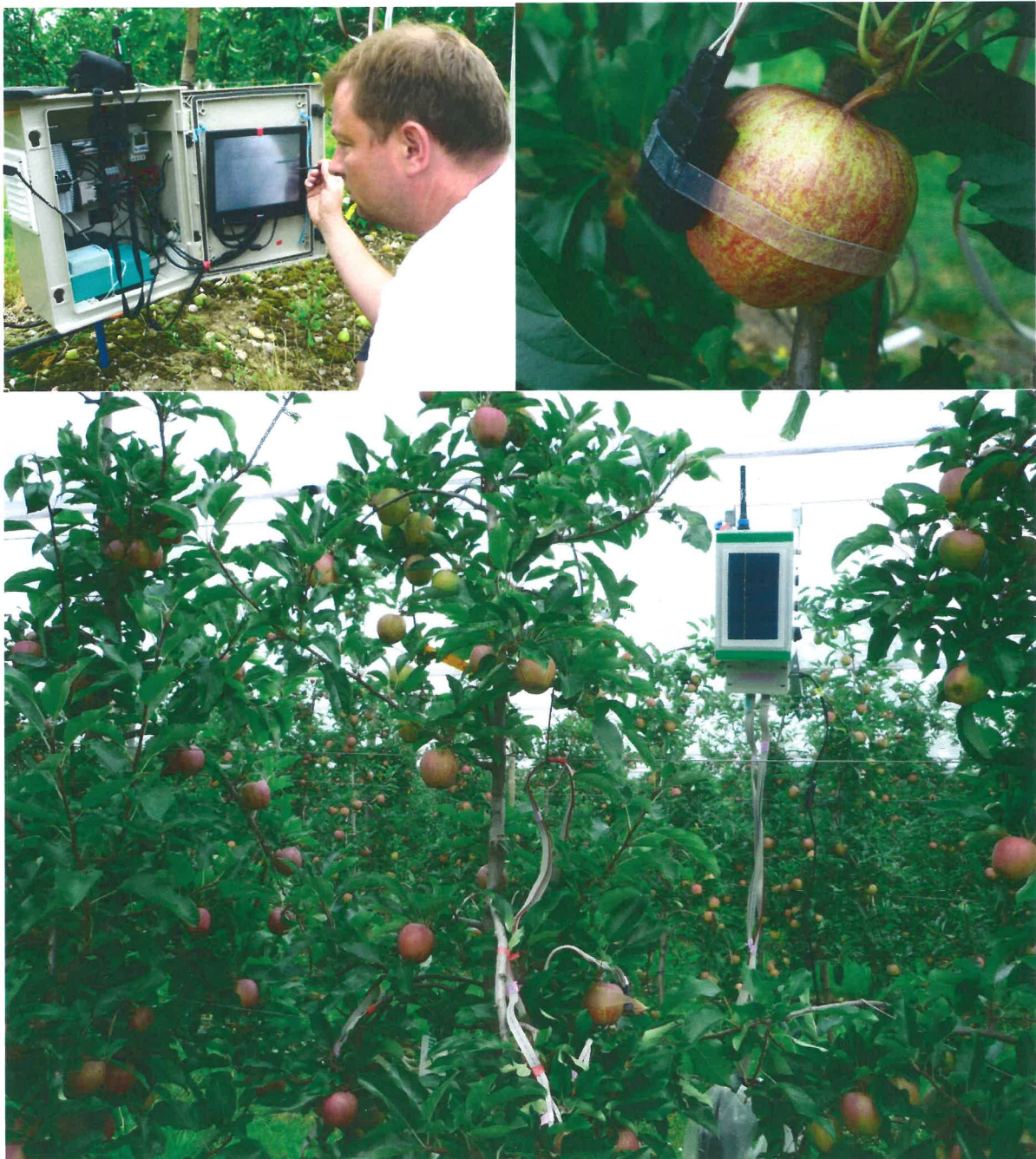
Abb. 1: Messaufbau zur automatisierten Messung mit dem neuen optischen Fruchtsensor im Freiland.
