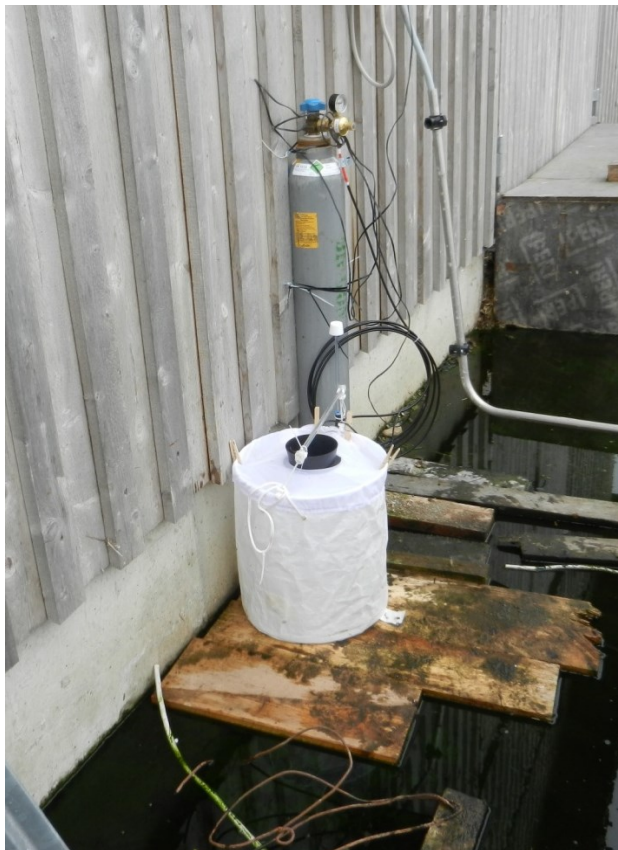
Abb. 3.2 BG-Sentinel Falle mit UV-Lampe und a CO 2 -Versorgung
