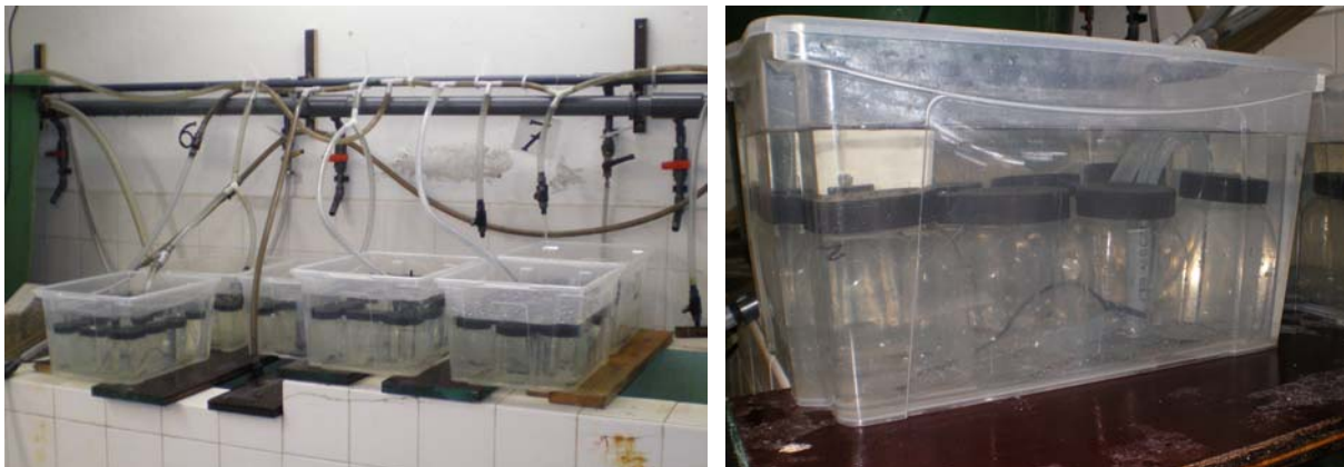
Abbildung 68: Versuchsaufbau für die Hungerversuche. Aquarien mit Kautexflaschen. In jede Kautexflasche wurde eine Garnele gesetzt.
