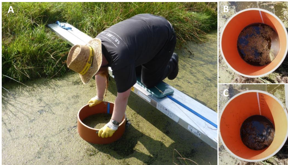
Abbildung 7-1: Beprobung der grabenlebenden Makroinvertebratenfauna mit der Stechrohrmethode. A) Einsetzen und Fixierung des Stechrohres. B) Vor Ausschöpfen. C) Nach Ausschöpfen der Wassersäule. Die untere Kante des Stechrohres ist angeschrägt, um das Einbringen in das Sediment zu erleichtern.
