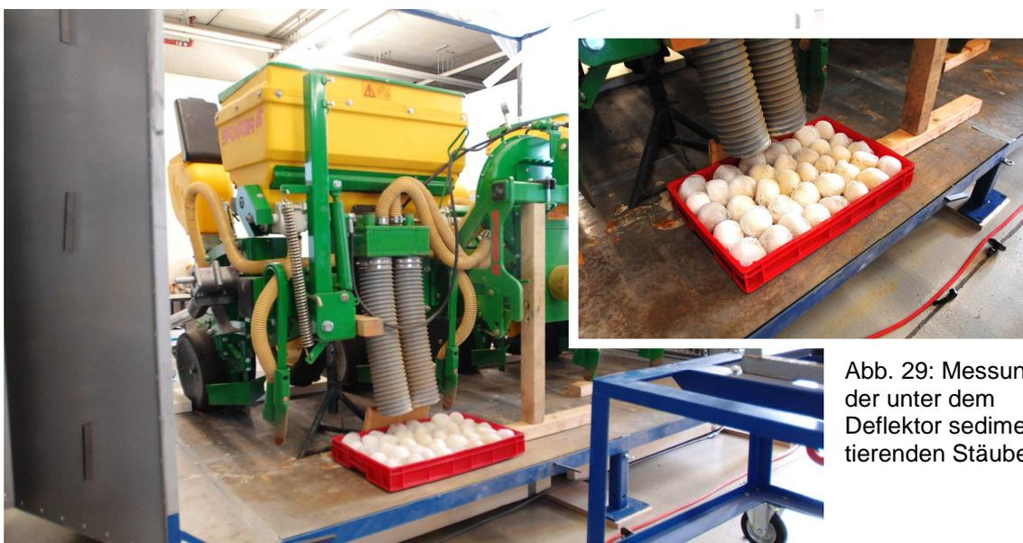
Abb. 29: Messung der unter dem Deflektor sedimentierenden Stäube
