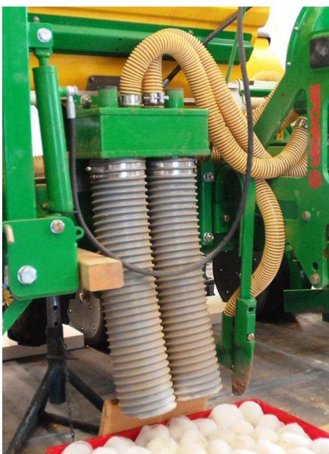
Abb. 31: Umrüstsatz (Deflektor) an einem Einzelkornsägerät
