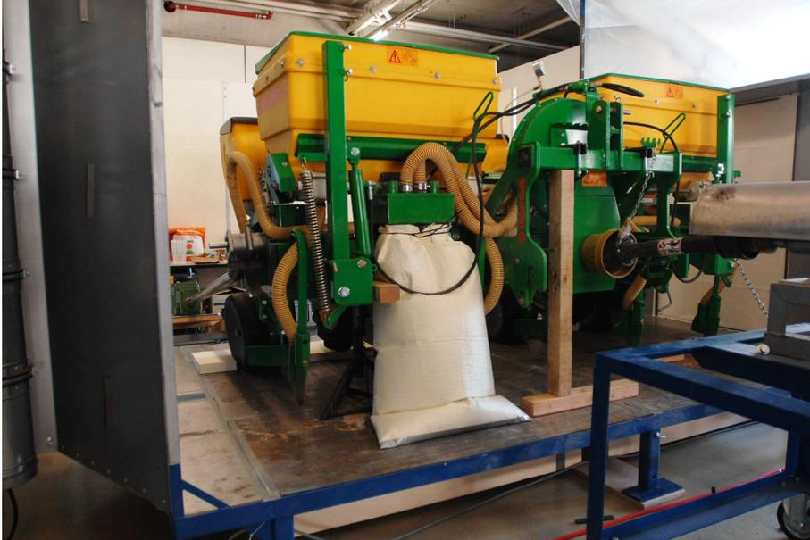
Abb. 33: Sack aus Filtrervlies zur Abscheidung der am Deflektor austretenden Stäube.
