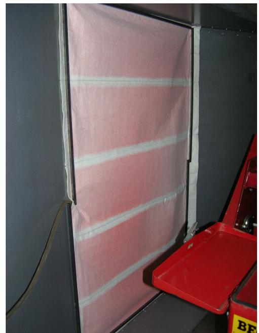
Abb. 18: Eingespanntes Filtervlies nach einer Sägeräteprüfung mit Wirkstoff.
