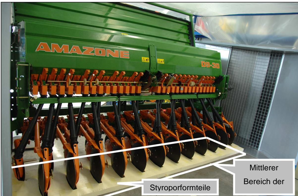
Abb. 16: Im Prüfstand aufgestellte Sämaschine mit Gitterrostabdeckungen
