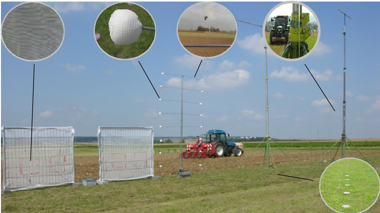
Abb. 22: Freilandmessung mit verschiedenen Kollektoren zur Bestimmung der Luftdrift („Airborne drift“).
