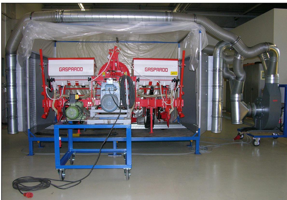
Abb. 15: Seitenansicht des Sägeräteprüfstands
