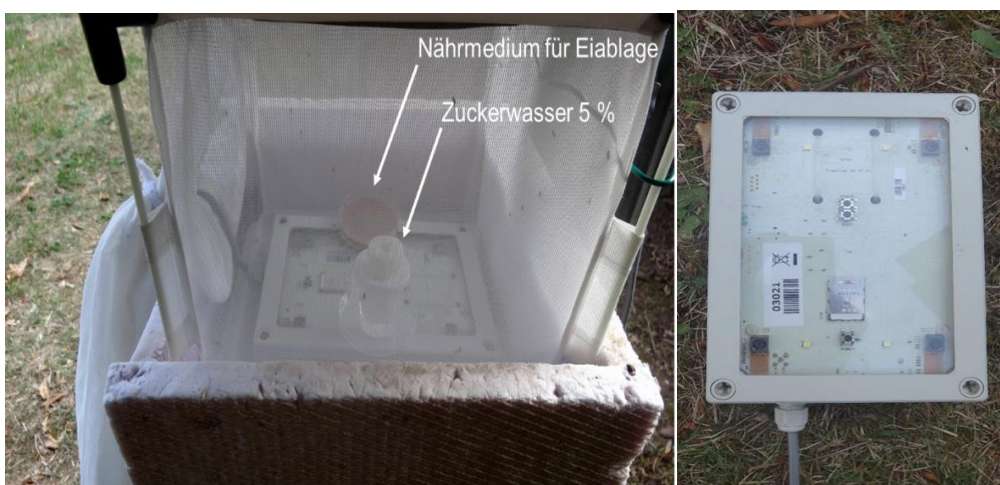
Abb. 15: Versuchsaufbau im Käfiginneren (links) und Trapview-Kamera (rechts)
