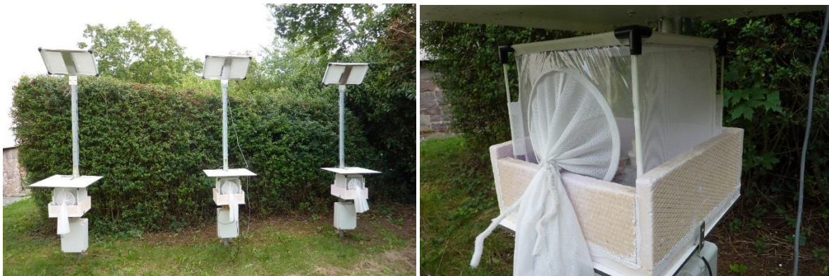
Abb. 14: Aufbau des Kameraversuchs zur Aktivitätsmessung im Halbfreilandversuch (links die drei identischen Versuchsaufbauten; rechts Netzkäfig in Wetterschutzeinfassung)
