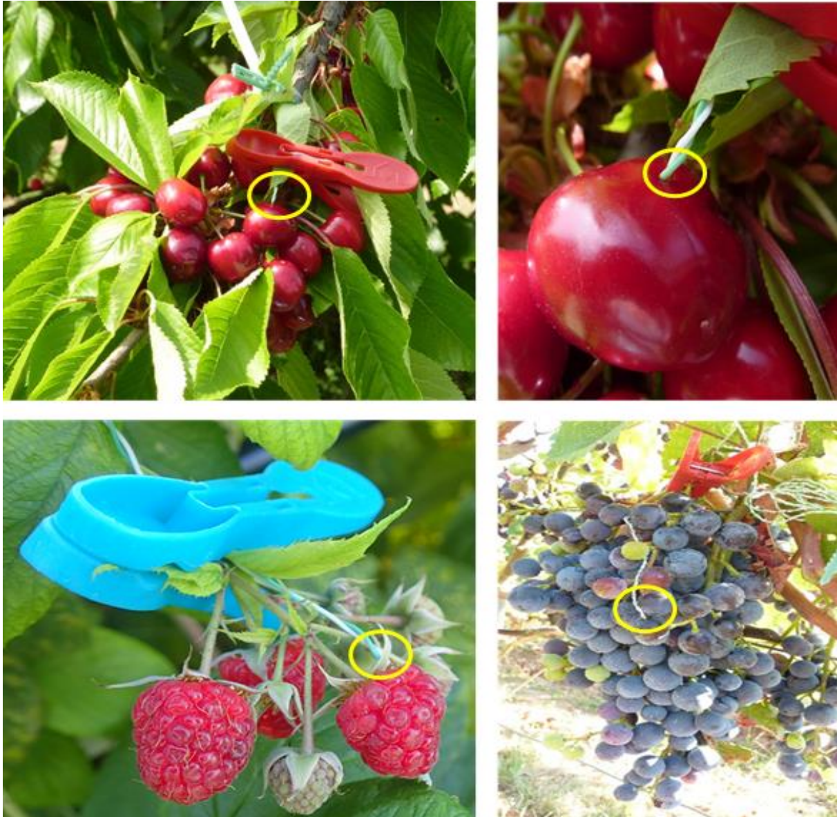
Abb. 12: Aufbau der Fruchttemperaturmessungen (Sonnenfrüchte) in Süßkirschen (links und rechts oben, 2018), in noch roten Brombeeren (unten links, 2020) und in Weinbeeren (unten rechts, 2018)
