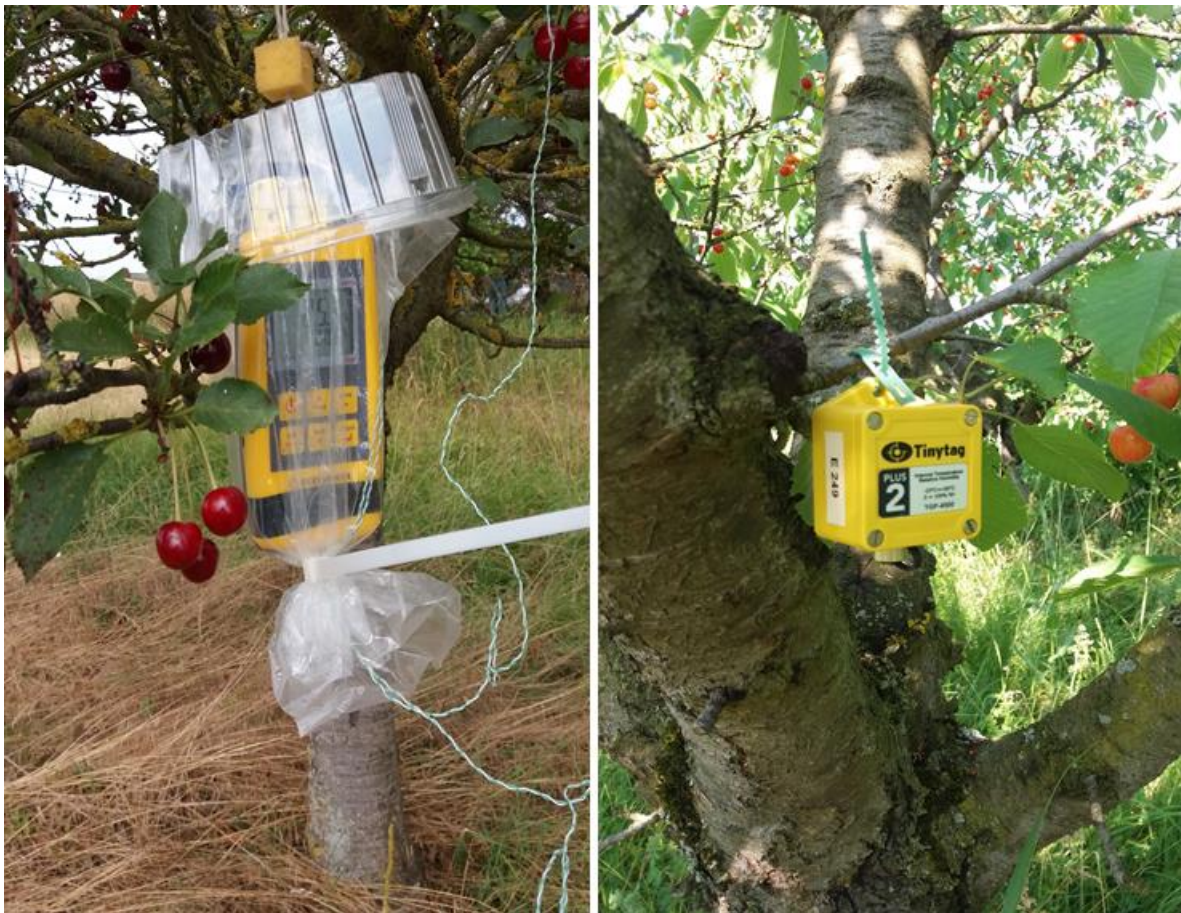
Abb. 11: Präzisions-Sekunden-Thermometer zur Messung der Temperatur im Fruchtfleisch von Kirschen und (Wein-)Beeren (links), Tinytag-Logger (rechts); Beispiel Süßkirschanlage, Heidesheim am Rhein, 2019
