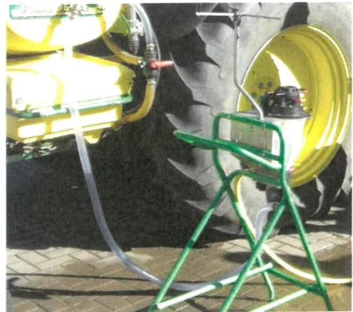
Abbildung 11: easyFlow an Feldspritze
