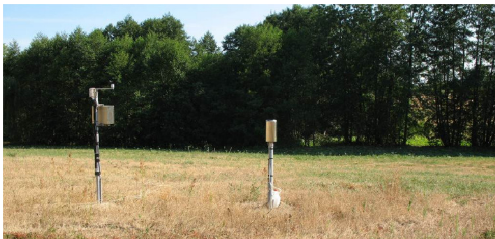
Abbildung 3: Messstation für meteorologische Größen an der Retentionsanlage Heinersdorf
