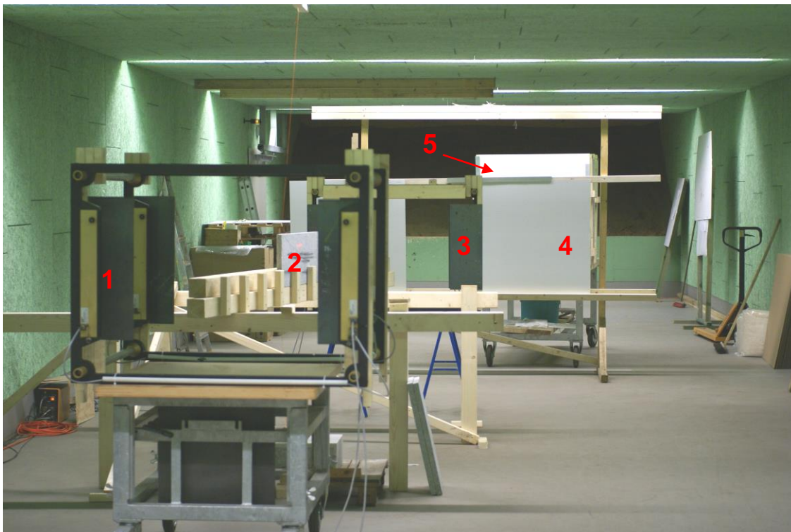
Im Bild: 1 = Eingangslichtschranke 2 = Steinplatte mit im Auftreffwinkel schräg gestelltem Balken 3 = Ausgangslichtschranke 4 = Indikatorwand 5 = Geschossfangkästen
