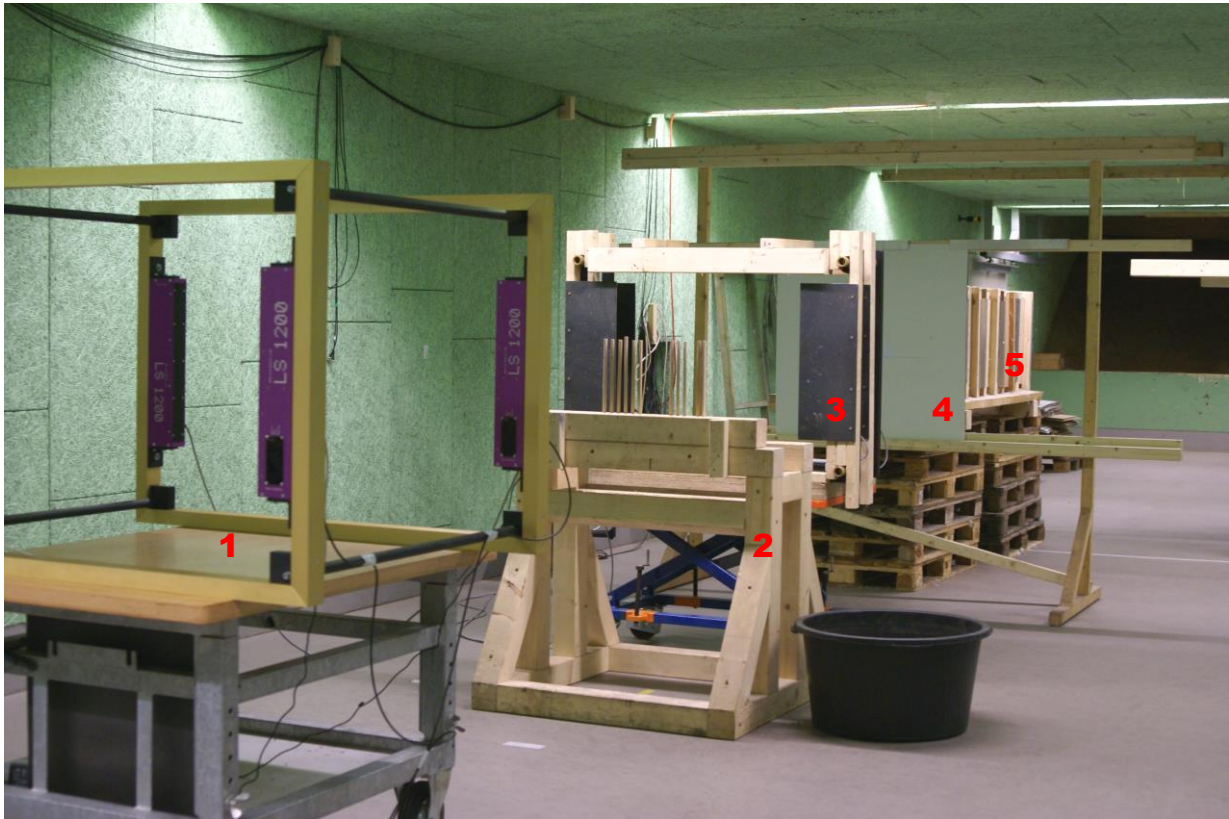
Aufnahme der Buchenstäbe im Holzbalken und massives Gestell (Pfeil) mit vollständigem Versuchsaufbau ( 1= Einganglichtschranke, 2 = Medium, 3 = Ausganglichtschranke, 4 = Indikatorwand, 5 = Geschossfangkästen).
