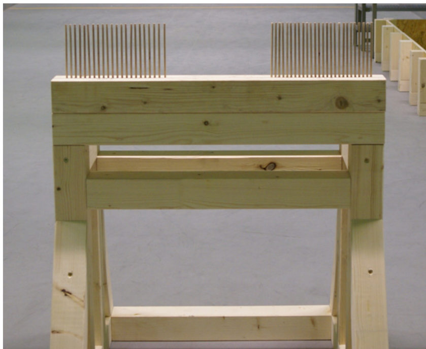
Aufnahme der Buchenstäbe im Holzbalken und massives Gestell
