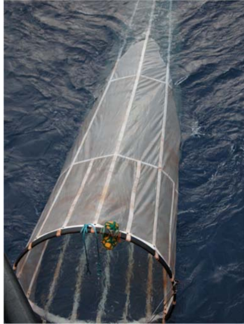
Abb. 2: Plankton-Ringnetz mit einem Öffnungsdurchmesser von 2 m.
