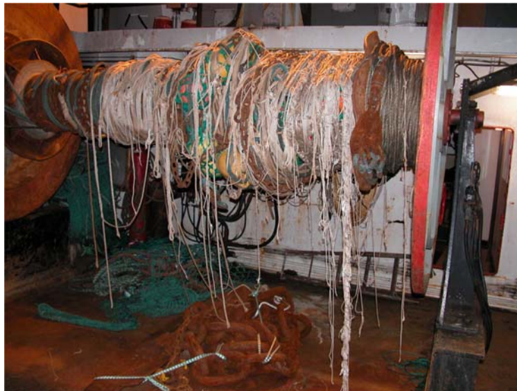
Abb. 6: Zerstörtes Netz nach vermutlicher Beschädigung durch einen Wal
