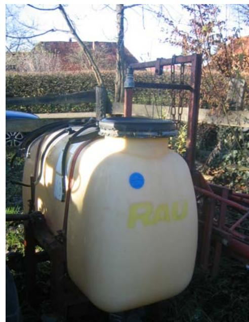
**Abb. 4.** Einfüllvorrichtung einer herkömmlichen Feldspritze
