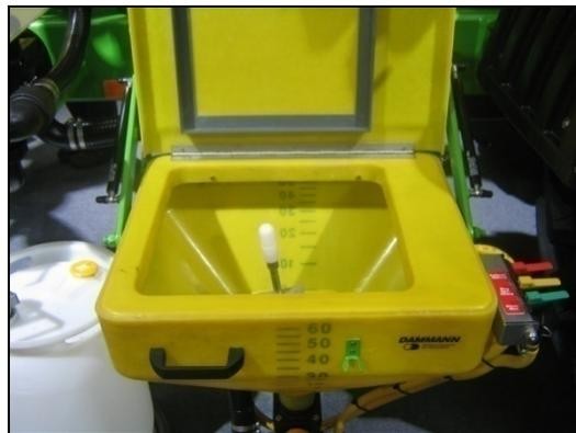
**Abb. 1.** Beispiel einer schwenkbaren Kanisterspülvorrichtung an modernen Applikationsgeräten
