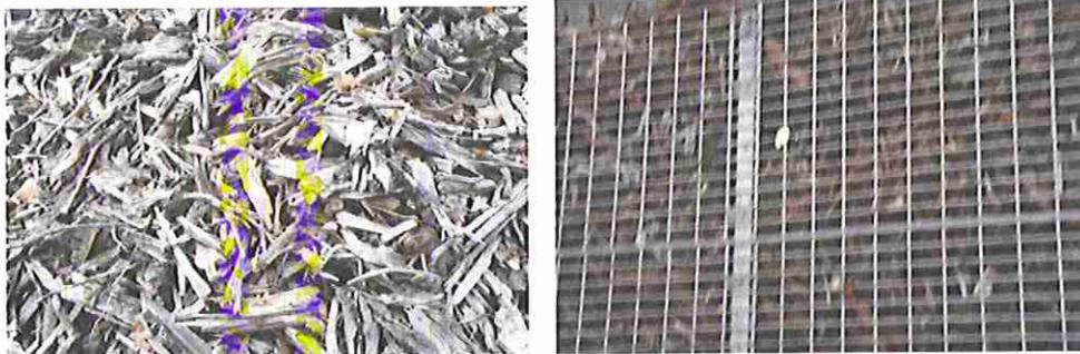
Abb. 24: Locker gepackte Wurzelholzschnitzel (a) mit Lichtdurchtritt (b) in der in Betrieb befindlichen baugleichen Anlage 1 in Drenkelveh
