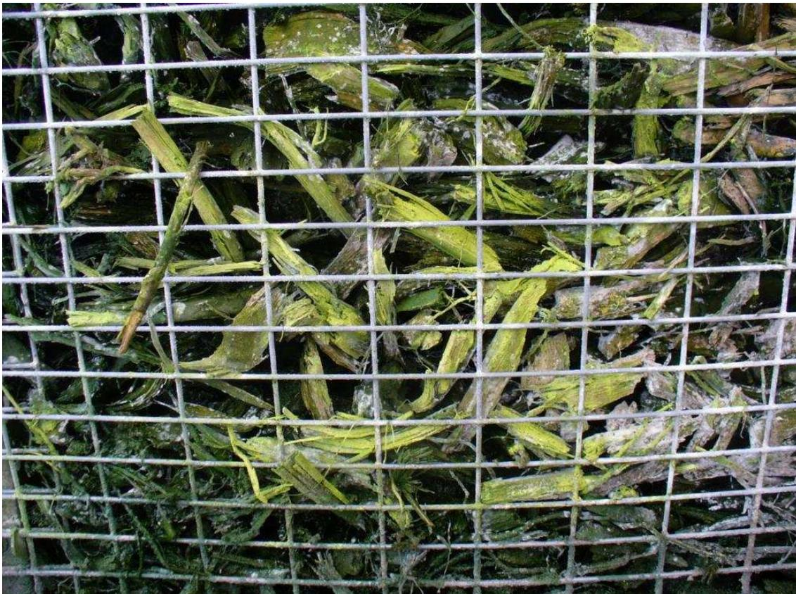
Abbildung 29. Blick auf die Reinluftseite des Biofilters in einem Segment mit erkennbaren und stark variierenden „Vergrünungen“ (25.05.2010)
