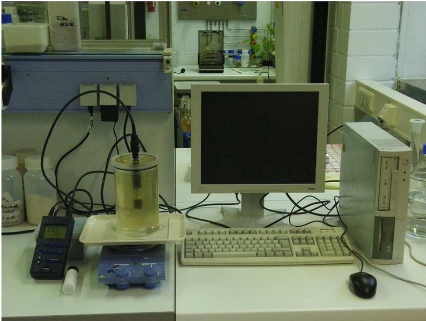
Abbildung 4. Messaufbau zur Bestimmung der Atmungsaktivität von Belebtschlämmen
