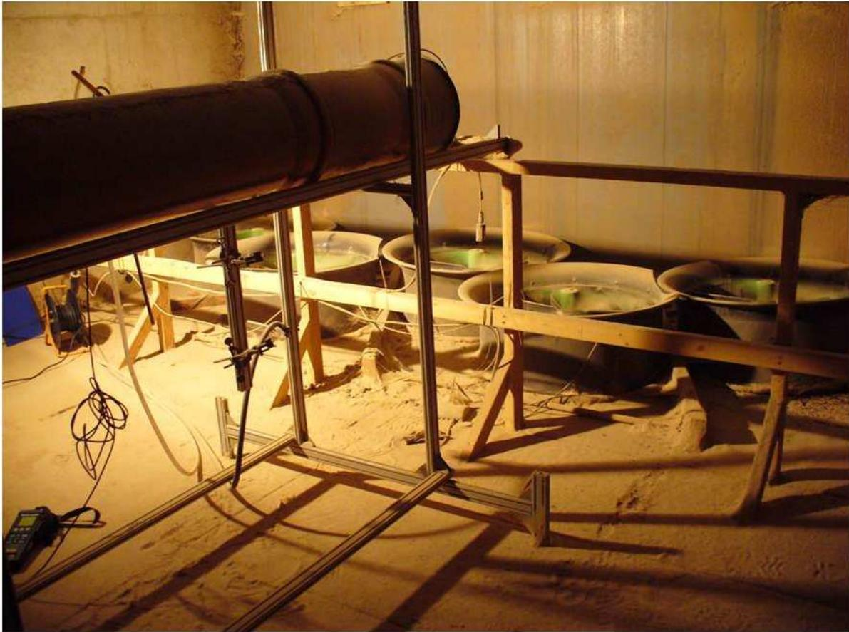
Abbildung 47. Blick auf das Messgasrohr für die Rohgasbeprobung sowie auf die Ventilatoren
