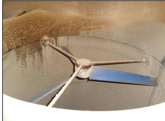
Abbildung 96. Stark verschmutzte und vernässte Messventilatoren (links 16.03.2010, rechts 12.04.2010)
