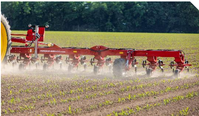
Abb. 1 Kameragesteuerte Schlepperhacke (©Horsch)
