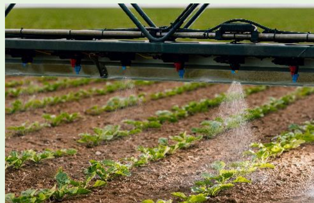
Abb. 2 Herbizid-Bandapplikation mit einer Feldspritze (©HORSCH)
