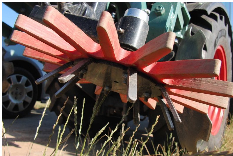
Abb. 25: Unterstern der Fingerhacke aus Stahl fixiert das System Scheibe Fingerhacke im Boden
