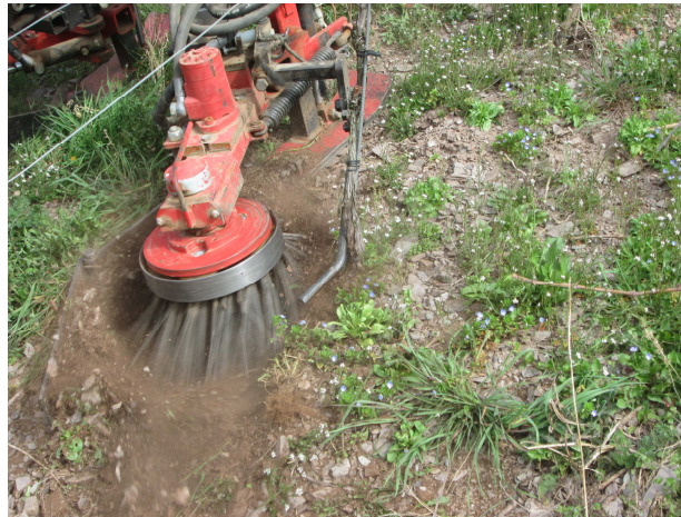
Abb. 22: Bearbeitung mittels NaturaGriff. Selbst bei trockenen Bedingungen bleibt die Staubentwicklung gering
