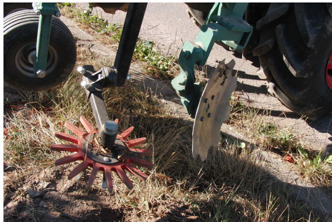
Abb. 24: Oberstern der Kress-Fingerhacke in Form eines leichten Kunststoffstern übernimmt die Funktion eines Abstandhalters zum Rebstock
