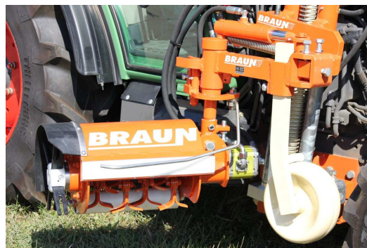
Abb. 3: Unterstockspindelmulcher der Firma Braun angebaut im Zwischenachsbereich eines Schmalspurschleppers
