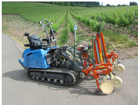
Abb. 20: Tastergesteuertes Flachschargerät der Firma Braun; Bearbeitung im Schubverfahren
