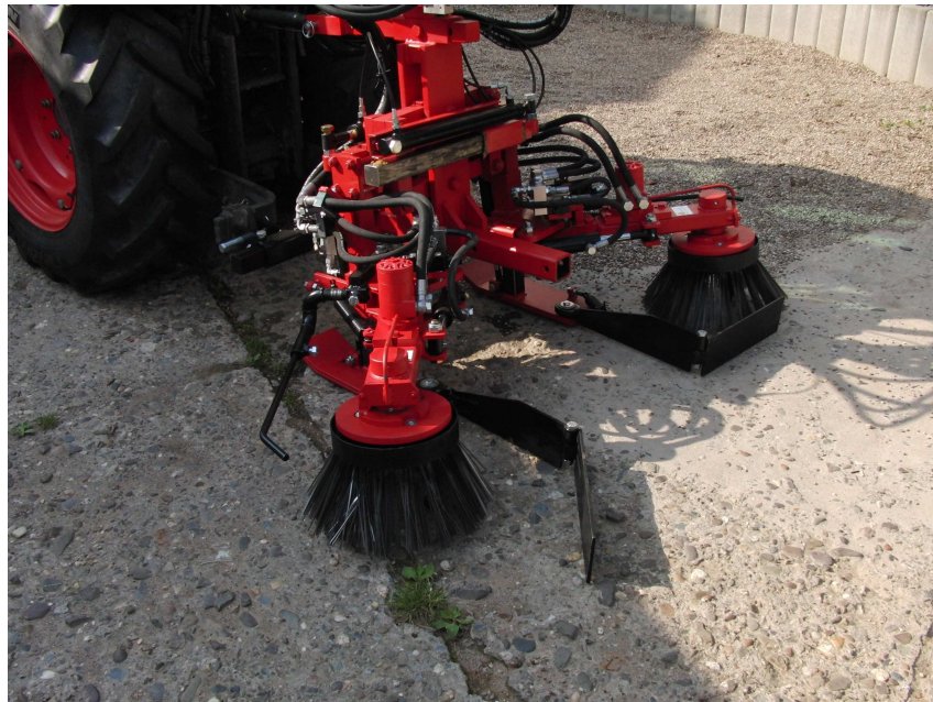
Abb.4: NaturaGriff Krautbürste 500. Gut erkennbar: die beweglichen Prallbleche
