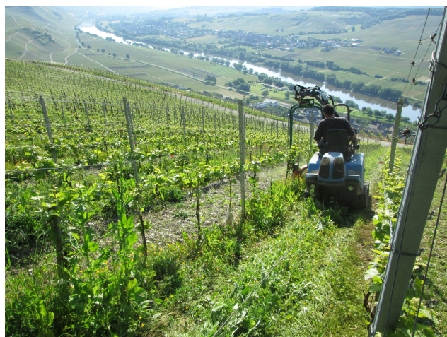
Abb. 19: Überzeilenbürste Multi-Clean im RMS Betrieb; das Umdenken bei der Bergfahrt verlangt dem Fahrer ein hohes Maß an Konzentration ab
