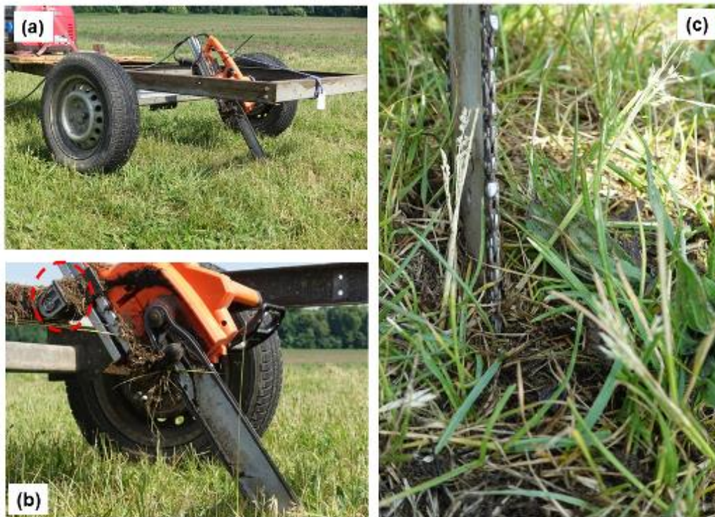
Abbildung 10: Konzeptstudie für einen neuen Bodenprobenehmer. (a) Übersicht; (b) Detail, mit Bodenaushub; (c) Eingriff in den Boden
