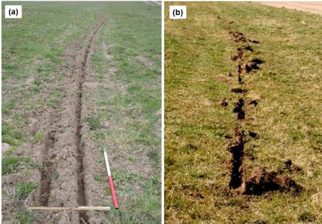
Abbildung 5: Verletzung der Grasnarbe. (a) Frische Furchen durch pH-Probennehmer und Spektrometerkopf auf lückigem Grünland. (b) Frische Furche durch pH-Probennehmer alter Grasnarbe
