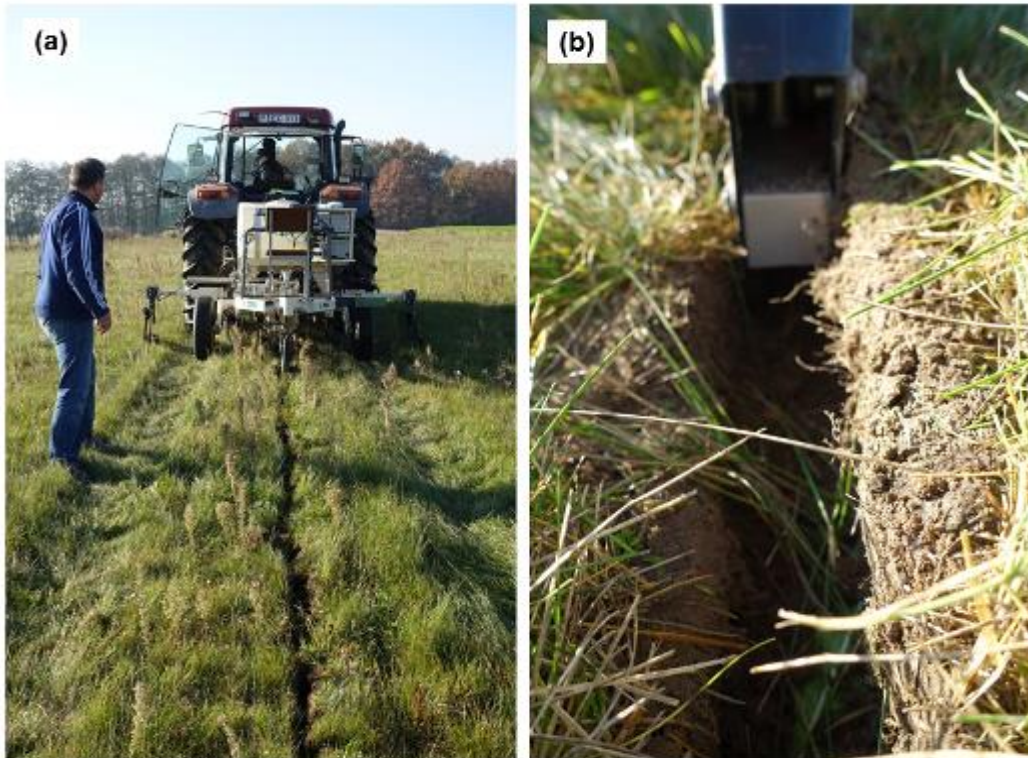
Abbildung 3: Verletzung der Grasnarbe (a) Messung mit der Veris Plattform auf langjährigem Grünland. (b) Furche durch den Spektrometerkopf
