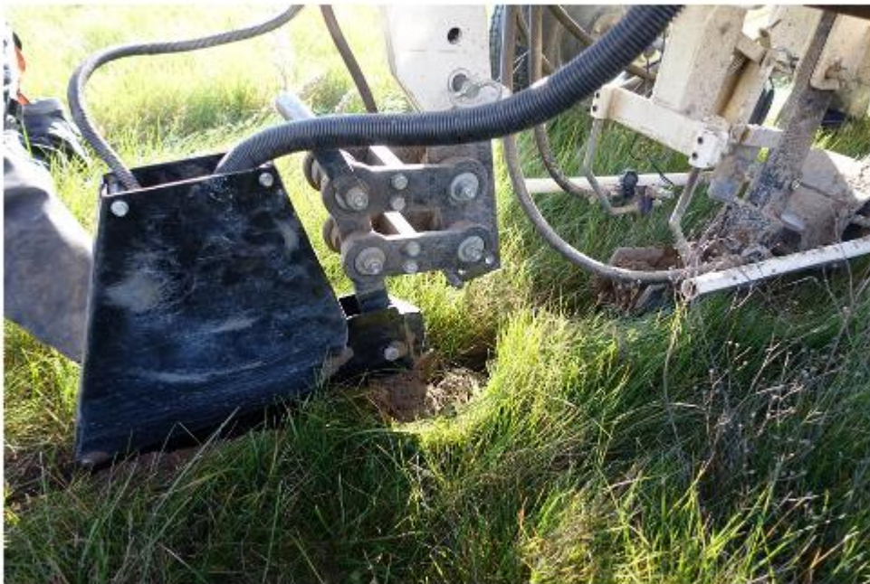
Abbildung 6: Verletzung der Grasnarbe. Spektrometerkopf (links) und Probennehmer pH (rechts) im Eingriff
