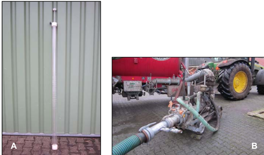
Abb. 1. Probensonde (A) für die repräsentative Entnahme von Gülleproben im Tiefenprofil von Güllesilos und Güllekellern (Hoeksma et al., 1995) sowie Bypass-Sammler (B) während der Befüllung des Vakuumtankwagens über einen mobilen Ansaugstutzen.
