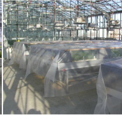
Abb. 6: Inkubation unter einer PVC-Plane.
