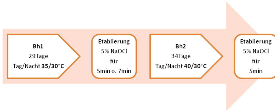
Abb. 3: Schematische Darstellung zum Ablauf der Thermotheapie zur Virusfreimachung mit den zwei aufeinander folgenden Behandlungsphasen (Bh1 und Bh2) unterschiedlicher Dauer und Temperaturführung und den jeweiligen Varianten der Etablierung (Natriumhypochlorid (NaOCl) Einwirkzeit und Konzentration)
