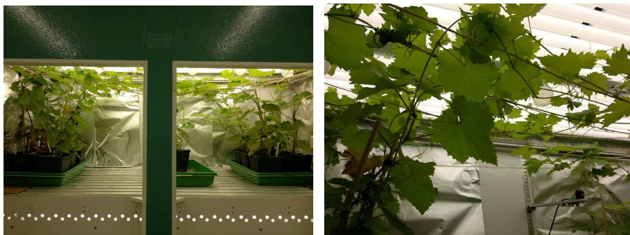
Abb. 2: links: Blick in die Klimakammer; rechts: an Seilen angeleitete Weinreben zur Thermotherapie in der Klimakammer
