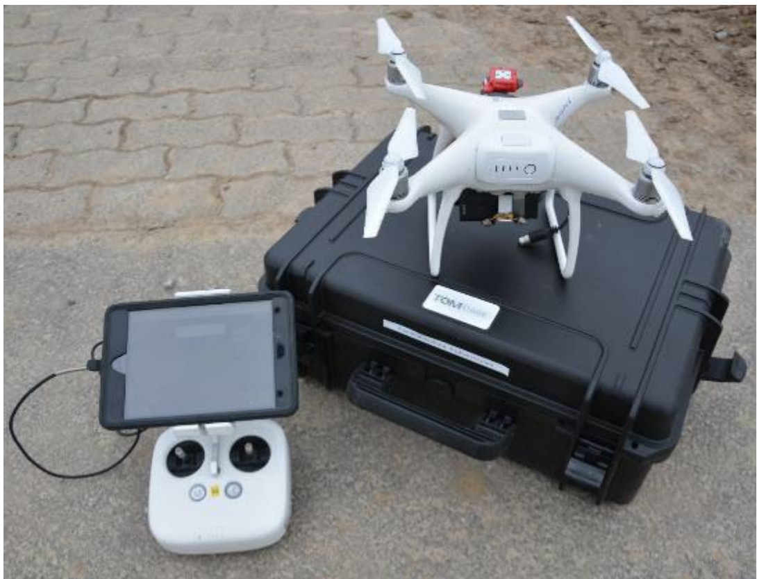
Anhang 16: Verwendete Drohrentechnik mit multispektraler Kamera
