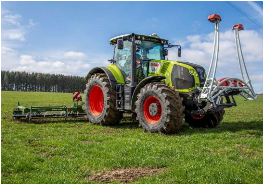
Anhang 9: Claas Axion 830 mit in der Front angebauten ISARIA Sensor
