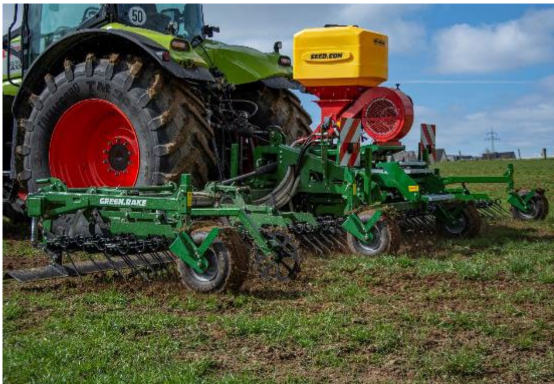
Anhang 8: Düvelsdorf green.rake Wiesenstriegel mit aufgesattelter seed.con Säeinheit
