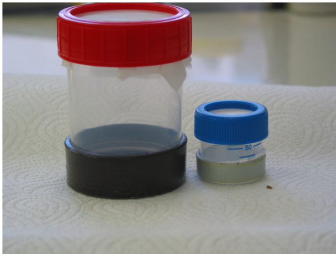
Abb. 5: Große Träger (120 ml) für die Einbringung von Se, verschlossen mit PE-Gaze (rechts) und kleine Träger (10 ml) zur Einbringung von Cms (links), verschlossen mit PTFE-Membran
