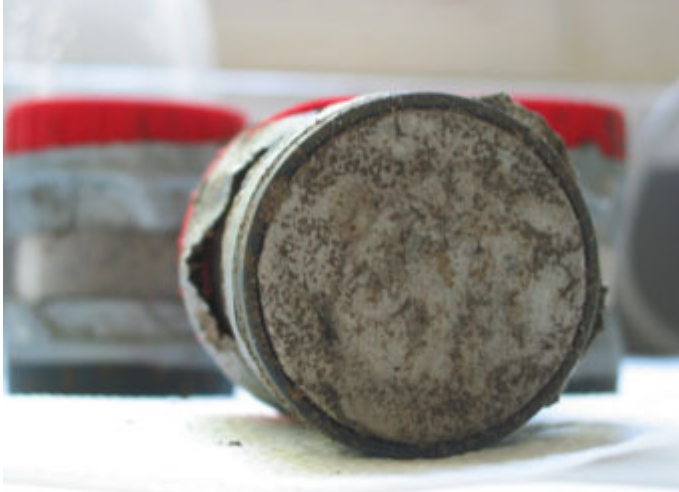
Abb. 6: Großer Träger mit einem Verschluss aus PE-Gaze nach 2 Monaten in der Kompostierung
