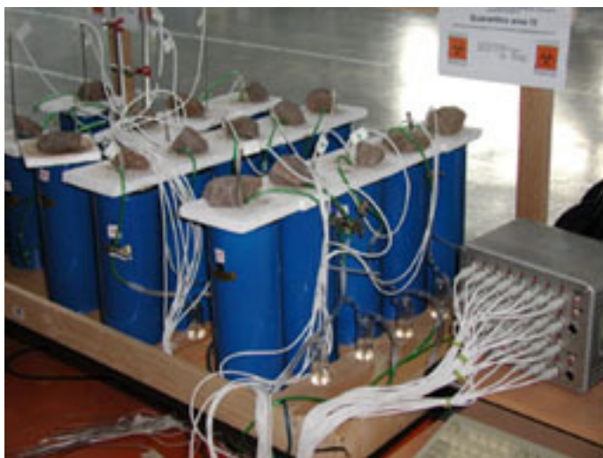
Abb. 3: 2-L-Dewar-Gefäße mit Regelung der Sauerstoffzufuhr während eines Kompostierungsversuchs
