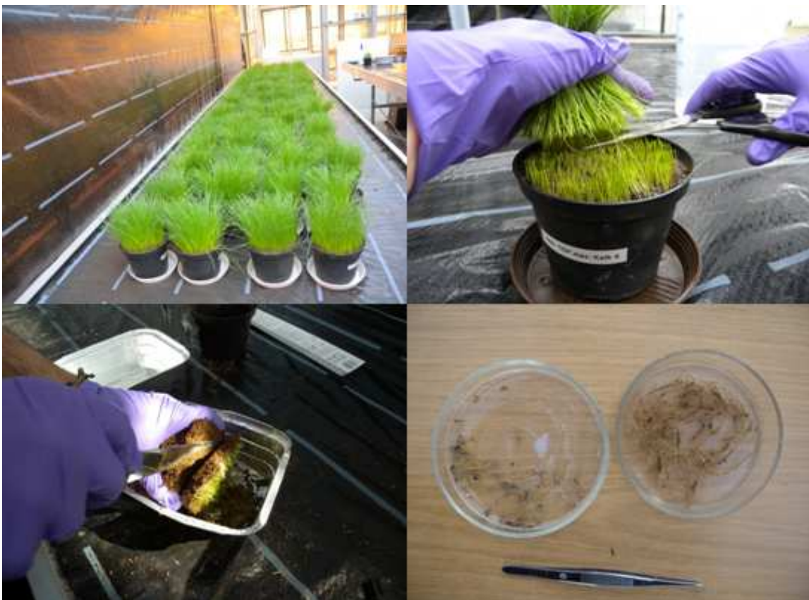
Abbildung 2-3: Anzucht von Weidelgras im Gewächshaus (oben links), Ernte der oberirdischen Pflanzenteile (oben rechts), Verwerfung des Wurzelansatzes (unten links) sowie manuelles Herauspräparieren von anorganischen Verunreinigungen der Wurzeln (unten rechts).
