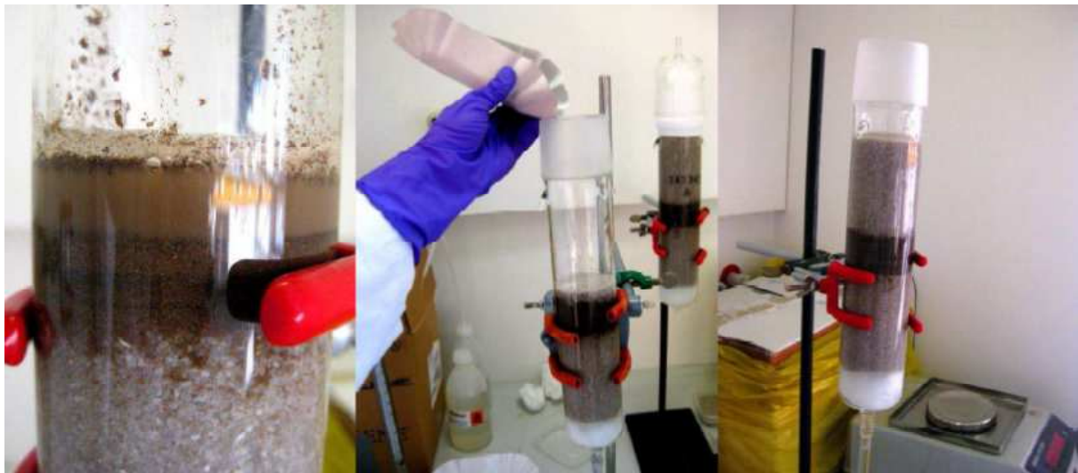
Abbildung 2-4: Einbau der Bodensäulen.
