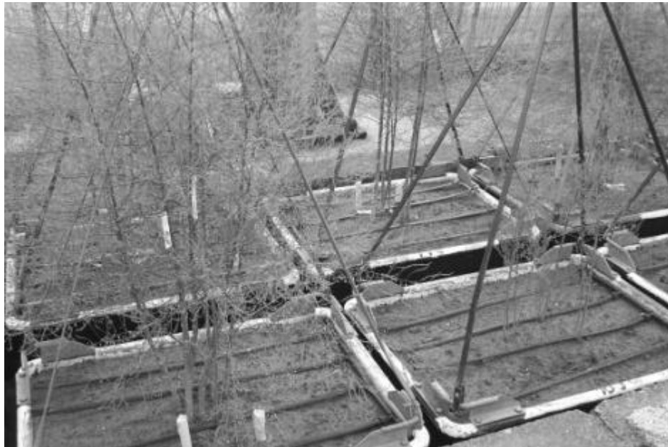
Abb. 1: Wägbare Lysimeteranlage für Bewässerungsuntersuchungen bei Spargel
