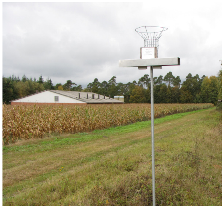
Abbildung 10: Messstelle mit Passivsammler „Zürcher“ (Standort Ne )
