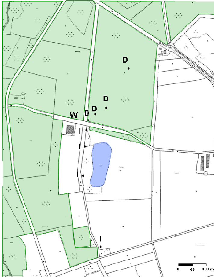
Abbildung 6: Messstandort Ne mit 4 Messstellen zur Ermittlung \text{NH}_3 -Immissionskonzentrationen (I), der N-Flüsse im Wald (D) und der Wetterstation (W)
