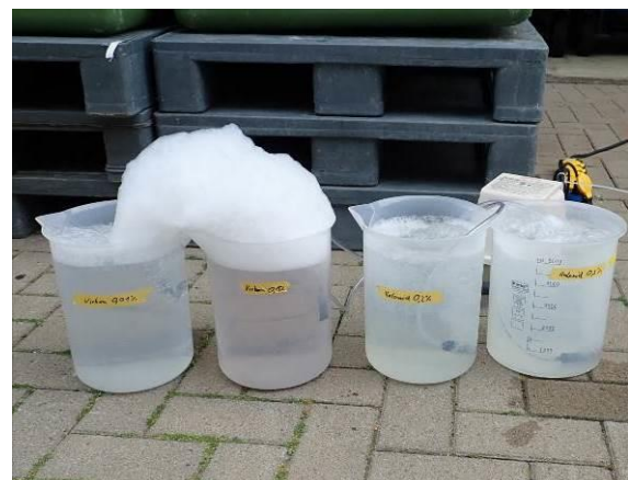
Foto 6: Versuchsaufbau mit Desinfektionsmitteln. Das Problem der Schaumbildung und des Chlorgeruchs konnte nicht gelöst werden.
