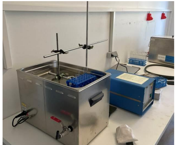
Foto 4: Ultraschallbad für die Desinfektions-versuche in Landau
