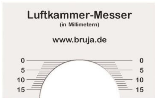
Abb. 132: Beispiel für die Bestimmung der Luftkammerhöhe beim Beleuchten (Werkbild)
