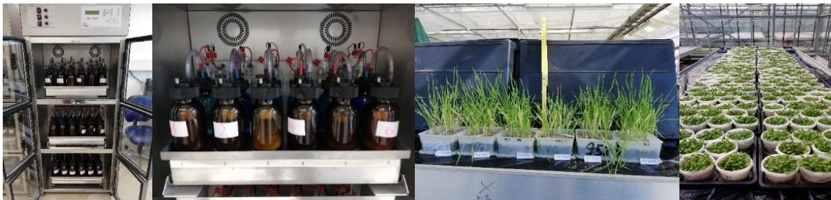
a b c d Abbildung 2.5-1: Inkubationsversuche und Pflanzenversuche. a = Respirometer-Brutschrank, b = Probengefäße im Respirometer, c = Wuchshöhe Roggen, d = großblättrige Kresse.
