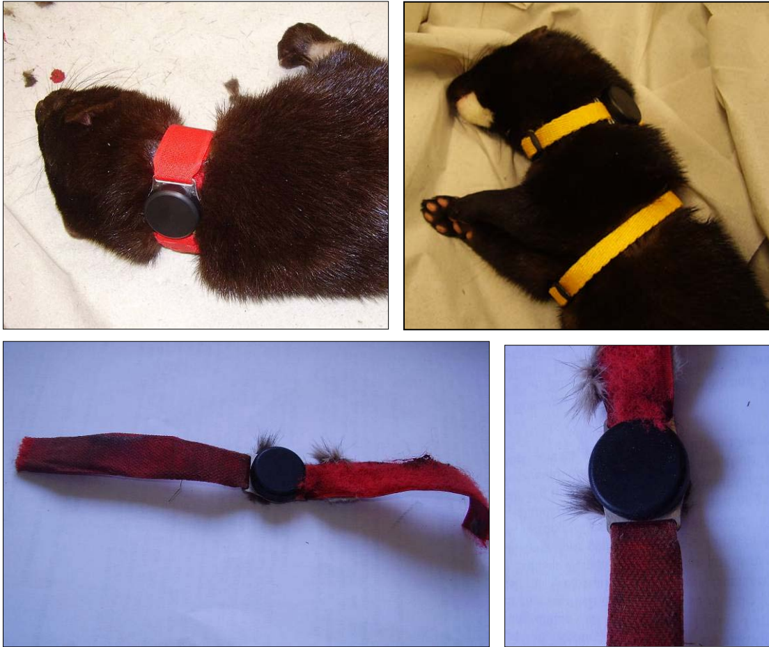
Abbildung 8: Oben: Befestigung der Aktometer mit Kletthalsband (links) und Nylongeschirr (rechts) am narkotisierten Tier. Unten: Abgestreiftes und zerbissenes Kletthalsband.
