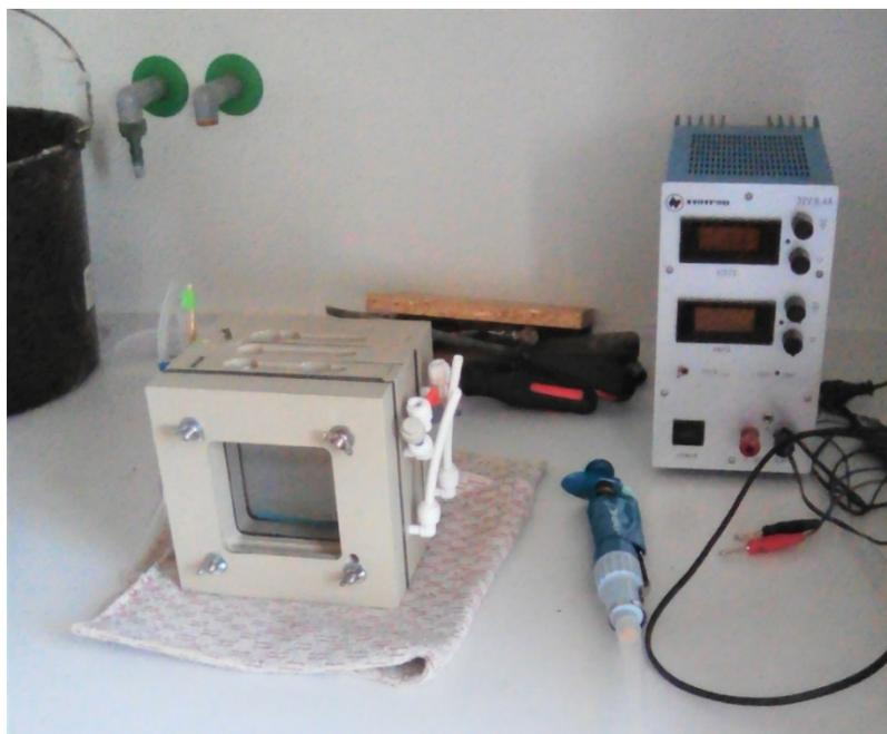
Abb. 3: Versuchsaufbau zur photokatalytischen Behandlung von Abwasser (Bereit gestellt durch den Partner in Istanbul).
