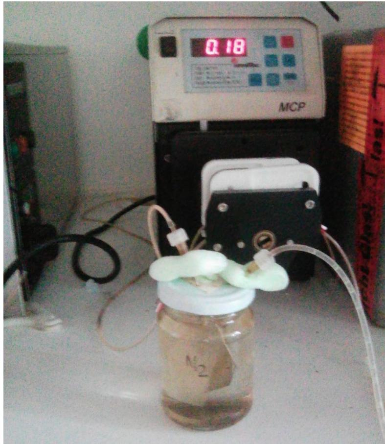
Abb. 1: Versuchsaufbau der Batchversuche
