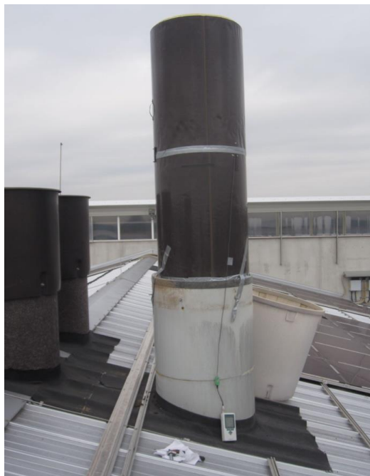
Abb. 29: Aufbau zur Kalibration des Messventilators an der LSZ Boxberg
