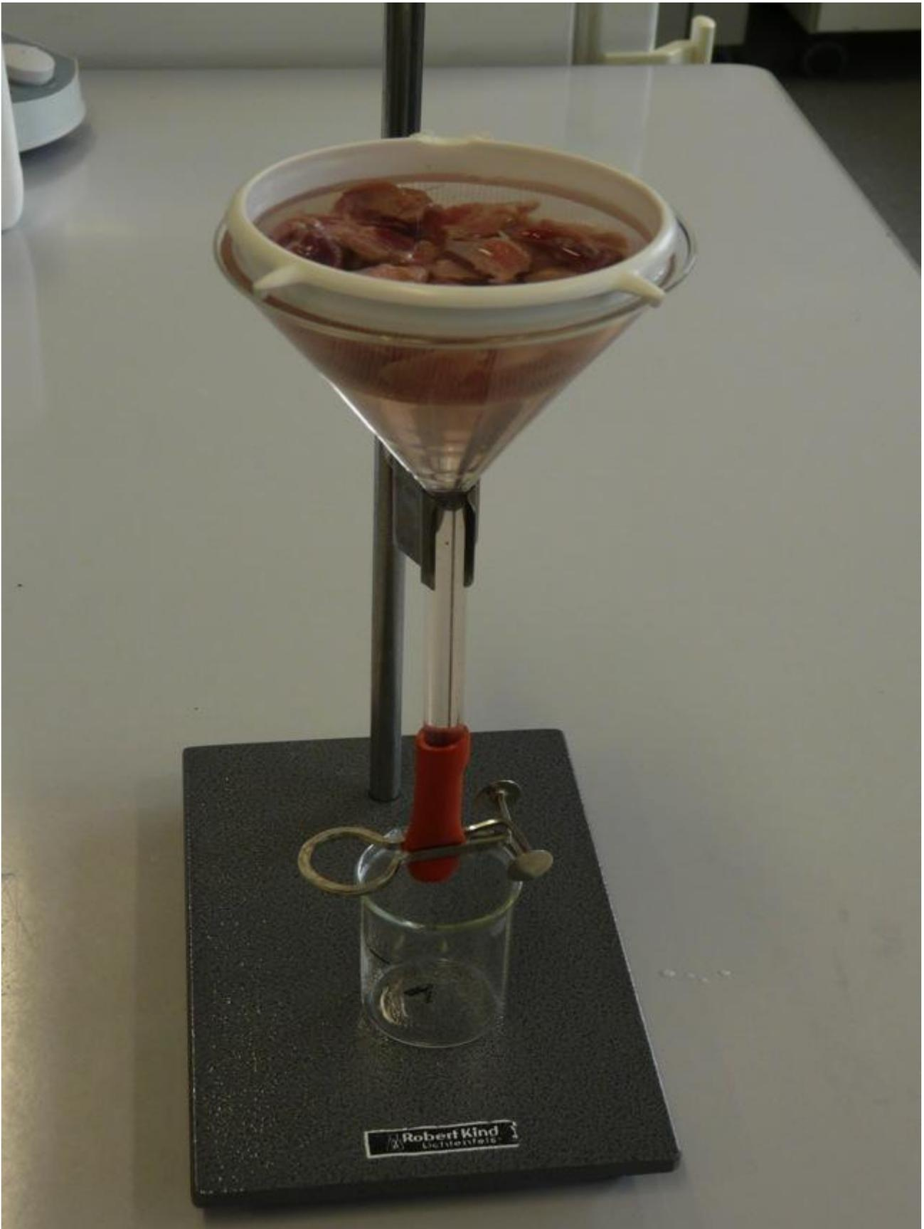
Abbildung 3: Darstellung des Versuchsaufbaus zur Durchführung der *Alaria alata* mesocercariae migration technique (AMT)
