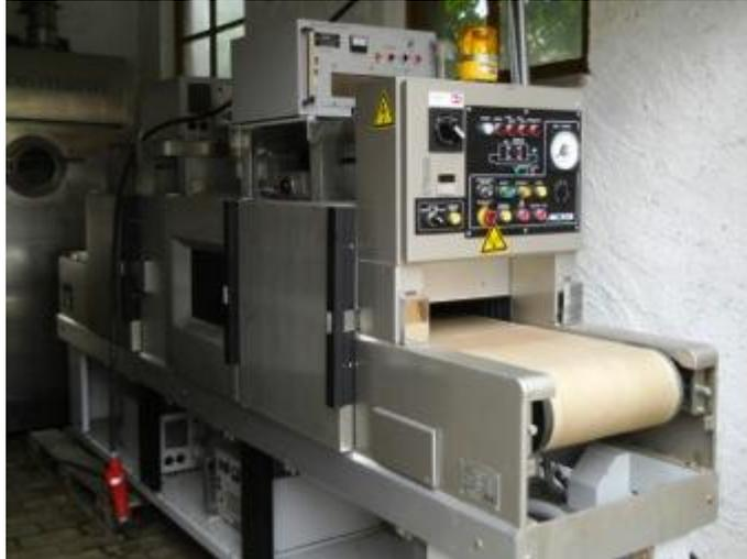
Abbildung 13: Verwendete Mikrowelle zur industriellen Bestrahlung von Lebensmitteln
