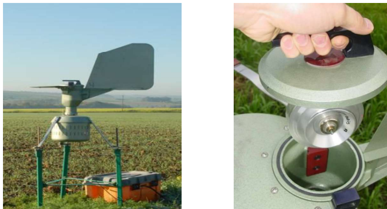
Abbildung 14: Burkhard-Sporenfalle mit Sporentapeband
