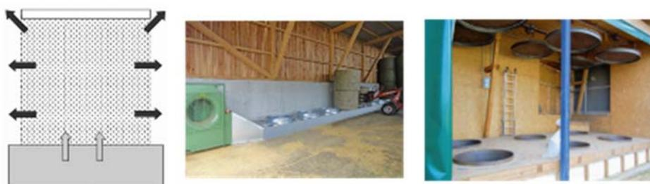
Abb. 8: Untenbelüftung: Luftstrom im Ballen und Beispiele für Anlagen (Holpp 2004, Firmenbild [www.lasco.at/rundballentrocknung](http://www.lasco.at/rundballentrocknung) 2015, Wirleitner 2016)
