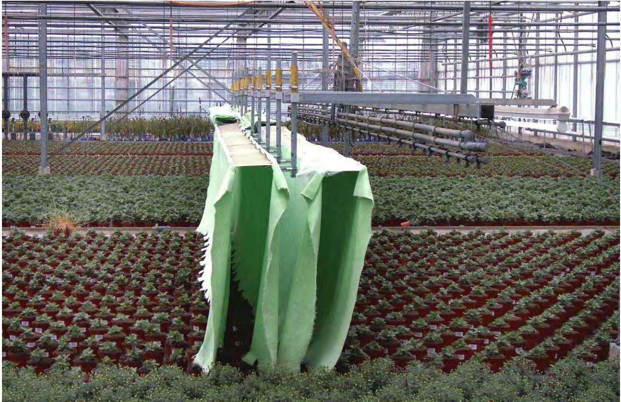
Abb. 95: Streichelanlage im Betrieb
