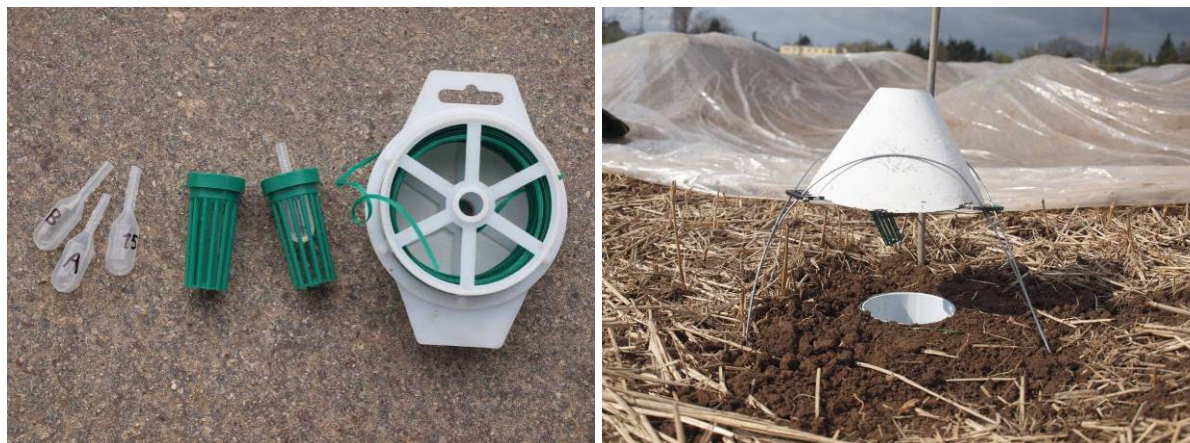
Abbildung 4.6: (Links) Duftstoff-Ampullen, Gitterbehälter und Befestigungsdraht. (Rechts) Fertige Bodenfalle mit Überdachung; unter dem Dach sieht man die mit Draht befestigten Gitterbehälter mit der darin befindlichen Duftstoffampulle.
