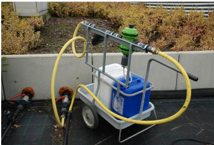
Abbildung 3.21: Mobiles Proportionaldosiergerät zur Einspeisung entomopathogener Nematoden in ein Tropfbewässerungssystem für eine Containerkulturfläche
