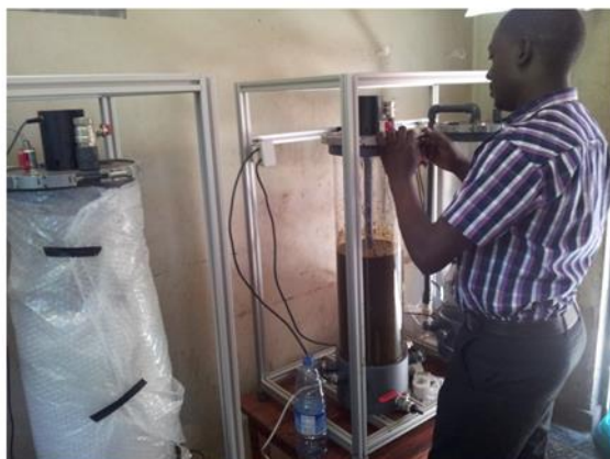
Vorab-Test der Biogasanlage, Makerere Universität, Uganda © Felix Redmer
