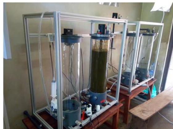
Vorab-Test der Biogasanlage, Makerere Universität, Uganda © Felix Redmer
